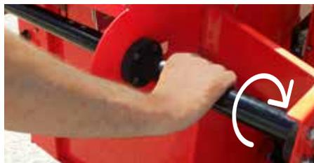
Controllo preciso dell'impianto con comandi ergonomici e movimenti dolci grazie al sistema di traslazione idraulico. È predisposto di comandi per il controllo della direzione, dell'acqua, del senso di rotazione e dell'inclinazione della spazzola.
