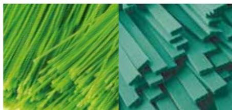
A seconda del veicolo da lavare si può scegliere tra due differenti materiali del nostro sistema di spazzole link-it: spazzole link-feel in polietilene ad alta densità adatte al lavaggio dei camion o spazzole link-foam in materiale anti graffio adatte soprattutto al lavaggio di flotte di autobus.
