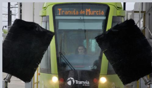
Disegnato appositamente per il lavaggio specifico della parte frontale e posteriore di flotte con linea di contatto aerea.
