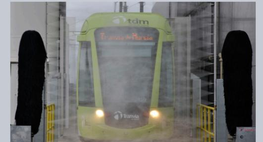
Disegnato per realizzare un prelavaggio dei veicoli con acqua ad alta pressione. La possibilità di scegliere l'elettropompa permette di variare la portata e la pressione dell'acqua sul veicolo attraverso le due tubature orientabili che includono ugelli d'acciaio inossidabile.
