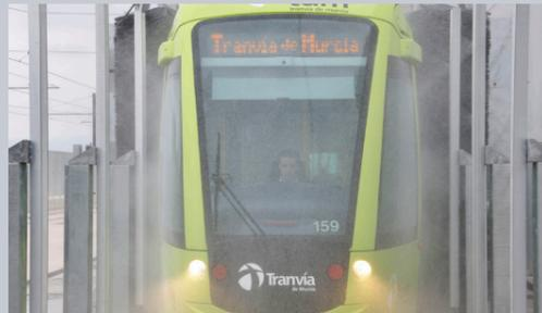
Optional disegnato per un'efficiente applicazione di prodotto chimico di prelavaggio. Composto da due tubature orientabili di acciaio inossidabile, ugelli con sistema antigocciolamento, sistema di dosaggio e protettori laterali per minimizzare correnti d'aria e ottimizzare l'applicazione del prodotto chimico.
