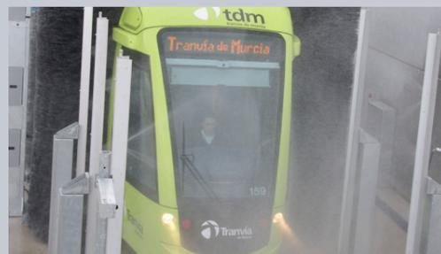
Un bagno di cera d'asciugatura o cera protettiva fornisce un'incomparabile brillantezza e protezione alla vernice dei veicoli di fronte alle aggressioni atmosferiche. Optional composto da due tubature orientabili sui propri assi e sistema di dosaggio centralizzato della cera.
