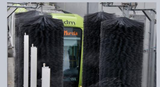
In aggiunta al gruppo di quattro spazzole verticali del modulo base si possono configurare fino a 4 gruppi di 2 spazzole verticali. Queste spazzole sono controllate da un automa programmabile, con regolazione elettropneumatica della pressione e sensori di assistenza allo sforzo di rotazione.
